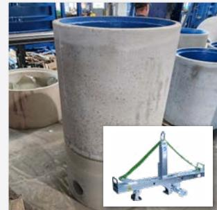
WDT. Schachtkomponenten werden werkseitig beschichtet und als Einzelteile angeliefert. Am Falz (Übergang der Schachtkomponenten) ist die WDT.-Dichtmasse zu verwenden, da nur damit die Systemgarantie besteht.
