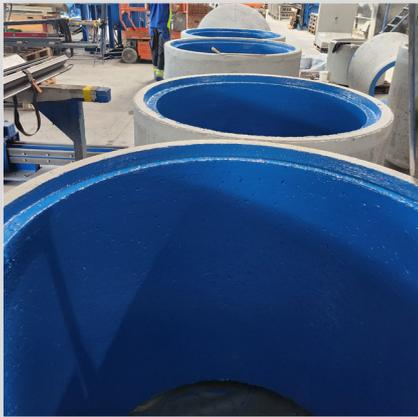
WDT. Schachtkomponenten werden werksseitig beschichtet und als Einzelteile angeliefert. Dichtmasse für den Falz (Übergang der Schachtkomponenten) wird mitgeliefert.
