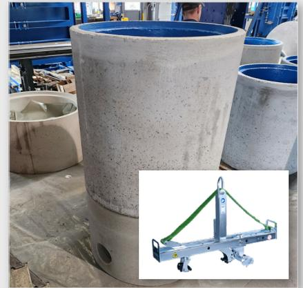
Schachtröhre aufeinander stellen, Beim Versetzen ist darauf zu achten, dass die Innenbeschichtung nicht verletzt wird. Bei Schachtzangen sind zwingend Schutzvorrichtungen anzubringen.
